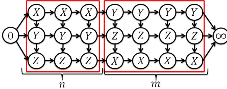
図 8. 3 段並列梯子型ネットワーク図  $K_{n,m}$
